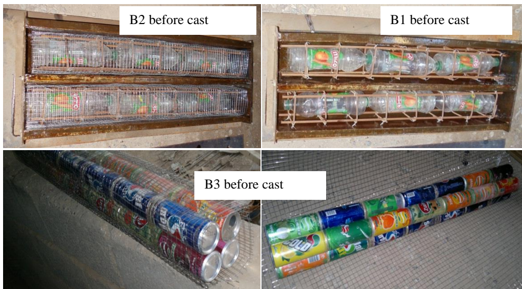
شكل (3) صور لبعض الاعتاب المجوفة قبل الصب
