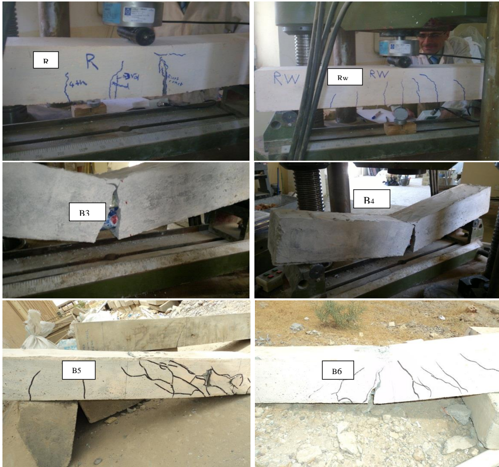
شكل (2) طريقة فحص الاعتاب تحت حمل مركزي ساكن مع شكل الفشل لبعضها
