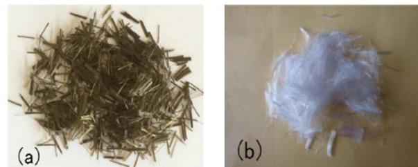
Fig. 15. a) Basalt Fiber b) Polypropylene Fiber [63].
