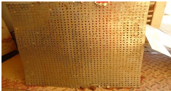
شكل 1: الألواح المثقبة المستخدمة في حوض الترسيب
